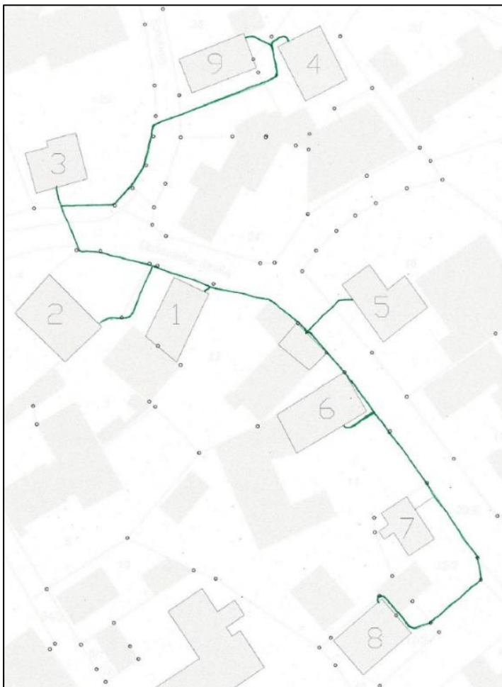
Abbildung 23: Topologie des Nahwärmenetzes Höll (3. Generation)
